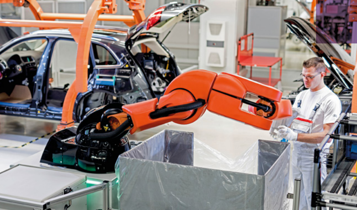
Cobots reiken onderdelen aan in de autofabriek van Audi (foto: Audi)
