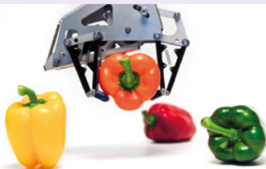
Een gripper van Lacquey voor groenten en fruit (foto: Lacquey)
