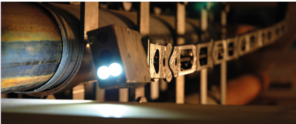
Snake-arm robot voor inspectie van moeilijk bereikbare locaties (foto: OC Robotics)
