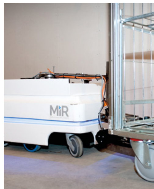
Klein en flexibel automatisch geleid voertuig (foto: Mobile Industrial Robots)
